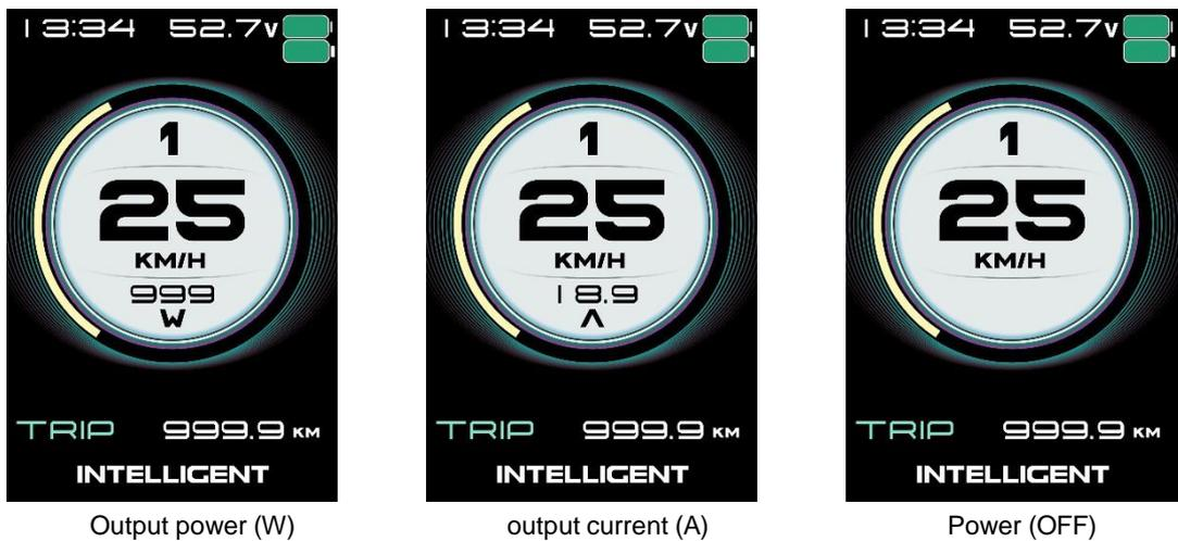
Nota: l'indicatore di potenza rappresenta la potenza (corrente) in uscita dalla batteria, non quella del motore.
